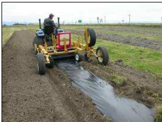
Photo 10 : Dérouleuse de plastique à plat
