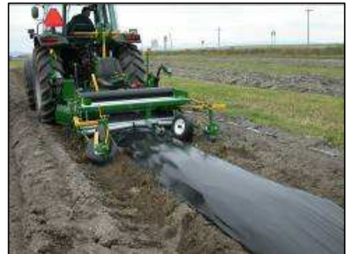
Photo 9 : Photo de la dérouleuse-butteuse en action
